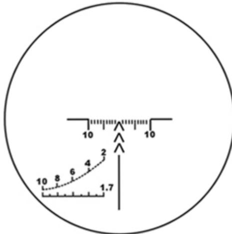
Mit der Skala links unten kann die Entfernung eines 1,70 Meter hohen Objektes geschätzt werden. Passt dieses ganz rechts zwischen die beiden Linien, so ist es 200 Meter entfernt. Passt es ganz links zwischen die Striche, so sind es 1000 Meter. Dieses Schätzen ist natürlich sehr ungenau und kein Ersatz zum Entfernungsmessen, welches z.B. durch einen Laserentfernungsmesser geschehen kann.
